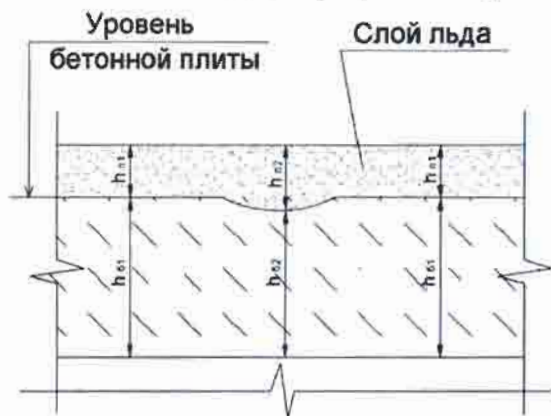
Рис. 1. Локальное нарушение горизонтальности бетонной плиты
